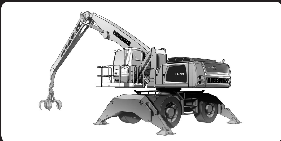
Abb.P_27: Modifizierter Unterwagen und neuer Fahrerarbeitsplatz, Visualisierung: J. Lorenz
