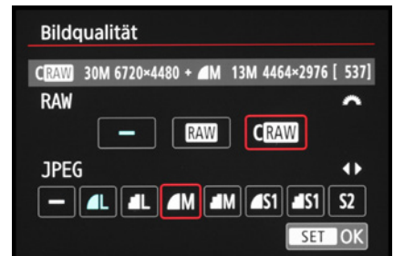
▲ Die benötigten Bedienungselemente werden eingeblendet, hier das Hauptwahlrad für die RAW-Einstellung und die horizontalen Cursortasten für die JPEG-Qualität.
