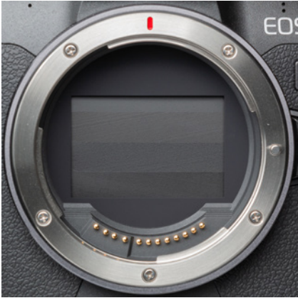
▲ Das neue RF-Bajonett mit zwölf elektrischen Kontakten. Der Sensor wird zum Schutz vor Staub und Beschädigung vom Schlitzverschluss abgedeckt, sobald das Objektiv entfernt oder die Kamera ausgeschaltet wird.
