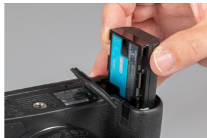
▲ In der EOS R können Akkus vom Typ LP-E6N und LP-E6 verwendet werden.
