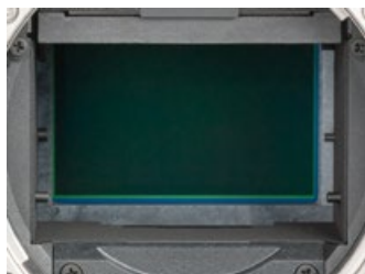
▲ Bei hochgeklapptem Spiegel ist der Vollformatsensor der EOS 5D Mark IV zu sehen (36 x 24 mm, 30,4 Megapixel).
