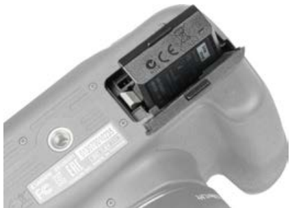
▲ Einlegen des Akkus hinter der Klappe an der Unterseite der 1200D.
