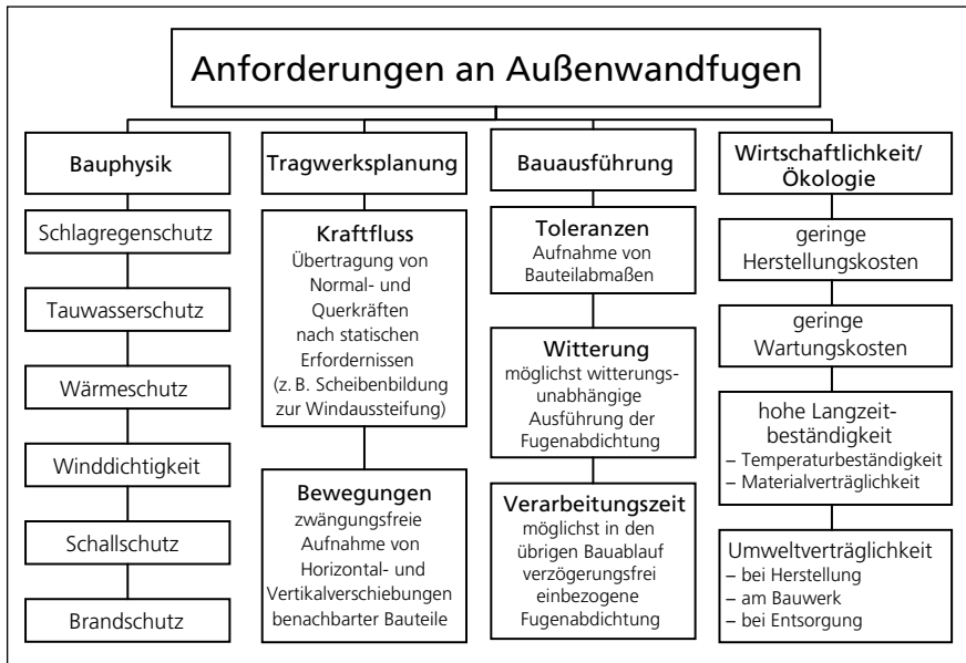
Bild 2 ■ Anforderungen an Außenwandfugen
