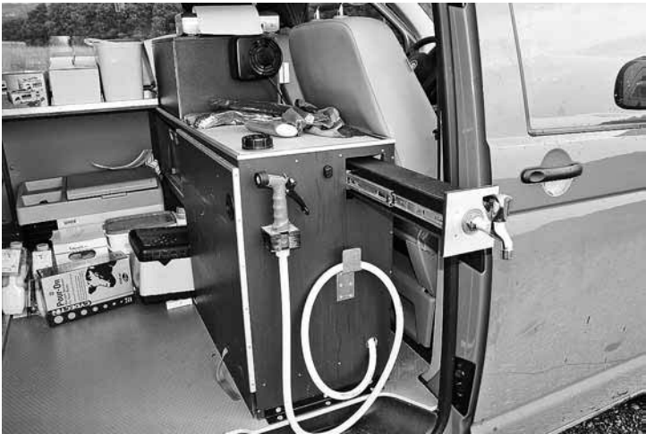
Abb. 1-2 Wasserversorgung im Dienstfahrzeug mit Kran und Stiefelbrause; im Hintergrund der mitgeführte Drucker.
