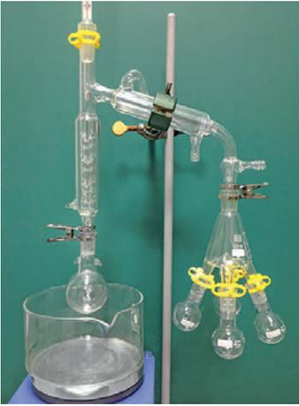
● **Abb. 1.8** Mikrodestillationsanlage zur fraktionierenden Destillation über eine Destillationskolonne (Vigreux-Kolonne)
