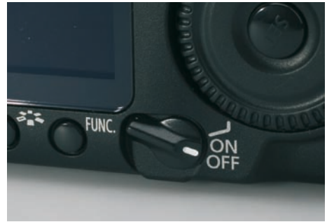
Der Ein-/Ausschalter links unter dem Daumenrad.
