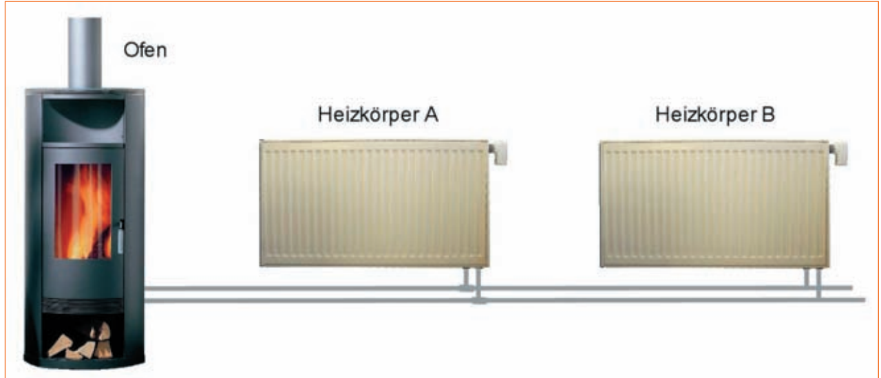
Abb. 4.11 – In kleineren Objekten – z. B. in Ferienhäusern – kann ein Kaminofen mit integriertem Wasserwärmetauscher bei Bedarf auch mehrere Räume gleichzeitig beheizen.
