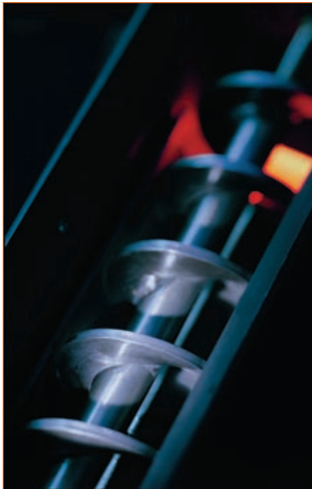
Abb. 4.28 – Die Förderschnecke des Pelletofens hat viel Ähnlichkeit mit der Schnecke eines Küchenfleischwolfs. Sie ist jedoch größer und länger und wird elektronisch so gesteuert, dass sie die Pellets jeweils optimal in den Brennertopf nachfüllt. (Foto: Wodtke GmbH)
