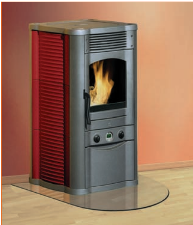
Abb. 4.24 – Ausführungsbeispiel eines kleineren Guss-eisen-Pelletofens, der bei Abmessungen von 49 x 91 x 50 cm (B x H x T) für eine Leistung von 4 bis 8,3 kW ausgelegt ist. Eine digitale Anzeige mit Wochen-Timer und Fernbedienung ermöglicht eine bequeme Bedienung. (Foto/Anbieter: Otto)
