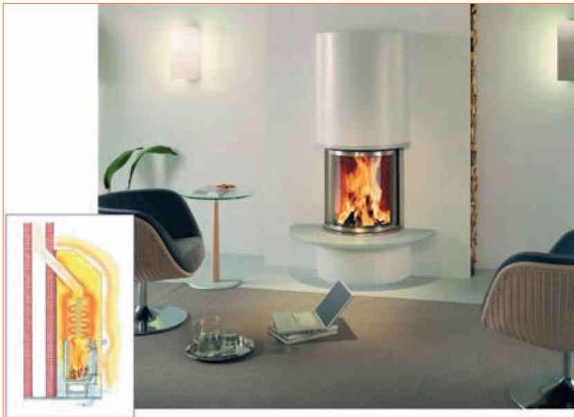
Abb. 4.21 – Ein sogenannter Speicherkamin ist ein offener Kamin, auf dem keramische Nachheizflächen aufgesetzt oder keramische Speichermassen hintermauert werden. (Foto: Ulrich Brunner GmbH, Keramik: Sommerhuber)
