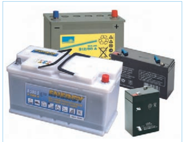
Abb. 3.1 – Als Energiespeicher eignen sich in der Photovoltaik alle Bleiakkumulatoren, die wahlweise in Form von Auto-, Solar-, Rollstuhlbatterien usw. erhältlich sind und meist eine Nennspannung von 6 oder 12 Volt haben (Foto/Anbieter: Conrad Electronic und Westfalia).
