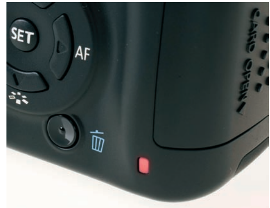
Blinkt die Lampe rechts unten am Gehäuse, sollten Sie das Kartenfach nicht öffnen, um die Karte herauszunehmen, weil die Kamera noch Bilddaten auf die Speicherkarte schreibt.
