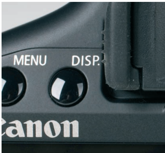
Drücken Sie die Taste DISP mehrmals, um sich die Kameraparameter groß auf dem Monitor anzeigen zu lassen oder das Display abzuschalten.
