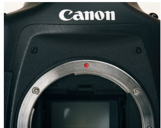
Hier darf kein EF-S-Objektiv angesetzt werden! Am Gehäuse der Canon 1D Mark II ist nur ein roter Punkt zu sehen. Die Kamera ist also nur für EF-Objektive geeignet.
