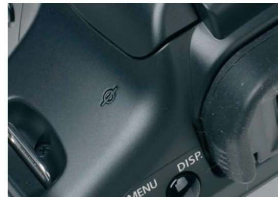
Die Okularabdeckung über dem Sucher lässt sich entfernen. Man kommt dann besser an das Rädchen zur Dioptrien-einstellung heran, außerdem lässt sich der Sucher besser reinigen.
