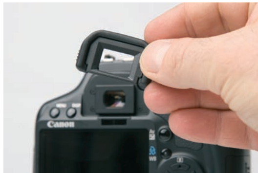
Die Okularabdeckung über dem Sucher lässt sich entfernen. Man kommt dann besser an das Rädchen zur Dioptrien-einstellung heran, außerdem lässt sich der Sucher besser reinigen.
