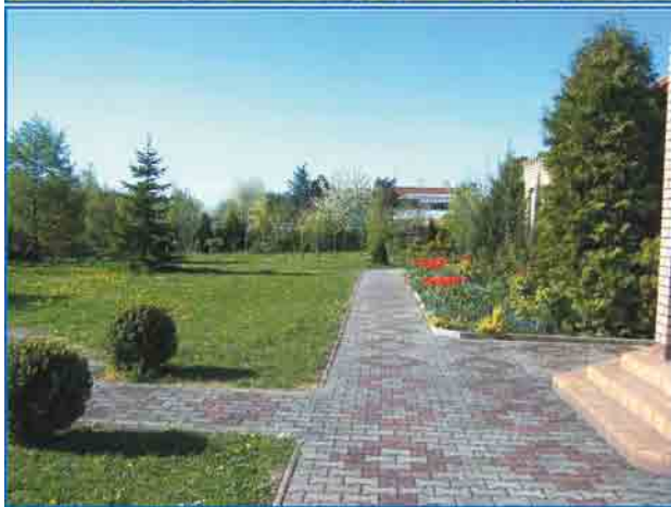
Abb. 3.10 – Betonsteine (Verbundsteine) sind oft in mehreren Farben erhältlich. Durch passende Farbmuster lässt sich die Eintönigkeit des Betons beleben.
