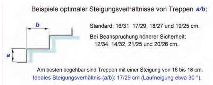
Abb. 5.4 – Richtmaße der Treppenstufen
