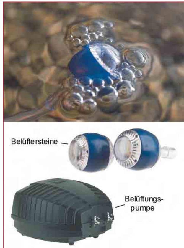
Abb. 9.7 – Das Teichbelüftungssystem Aqua Oxy 400/1000 ist für eine 230-V-Versorgungsspannung ausgelegt und besteht aus einer Belüftungspumpe mit zwei schwimmenden Belüftersteinen. (Foto/Anbieter: Conrad Electronic)
