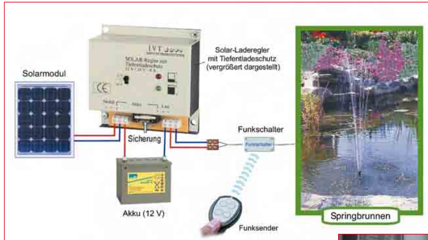
Abb. 9.5 – Beispiel einer solarelektrischen Stromversorgung einer Springbrunnenpumpe, die ihren Strom über einen Akku bezieht und fernbedient via Funkschalter geschaltet wird.
