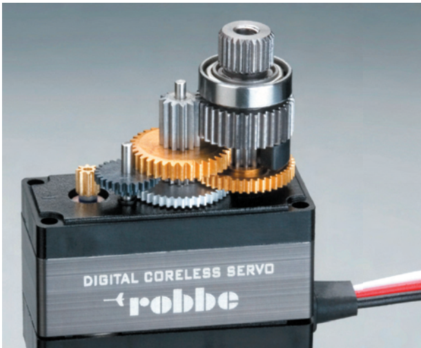
Abb. 6.4 – Hochleistungsservos sind selbstverständlich kugelgelagert.
