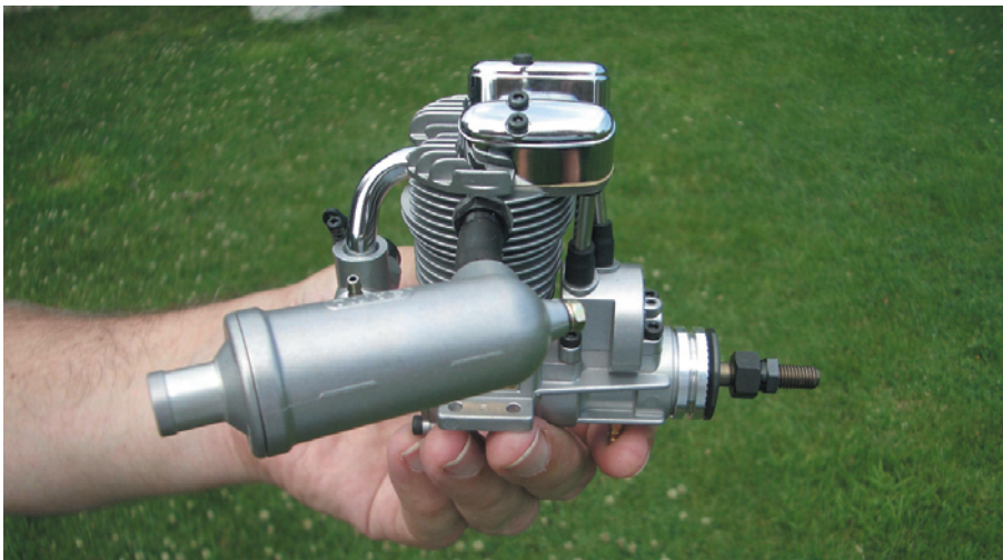
Abb. 6.19 – Auch bei Viertaktern kommen relativ einfache Schalldämpfersysteme zum Einsatz.
