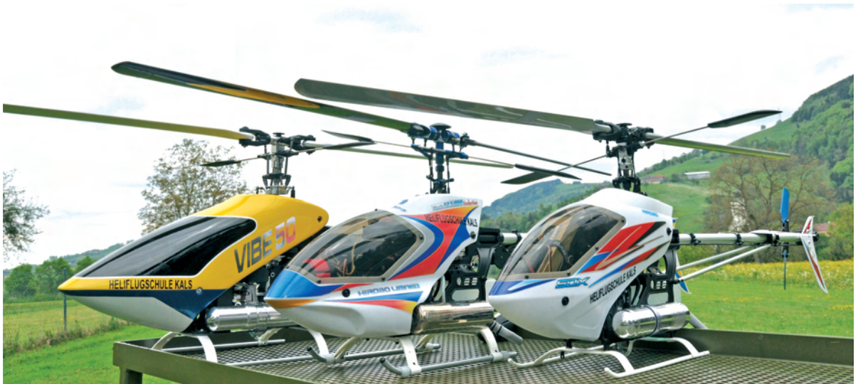
Bild 1.3: Paddelstangen sind deutlich kürzer als Rotorblätter. Sie tragen zur Stabilisierung des Hubschraubers in der Luft bei.
