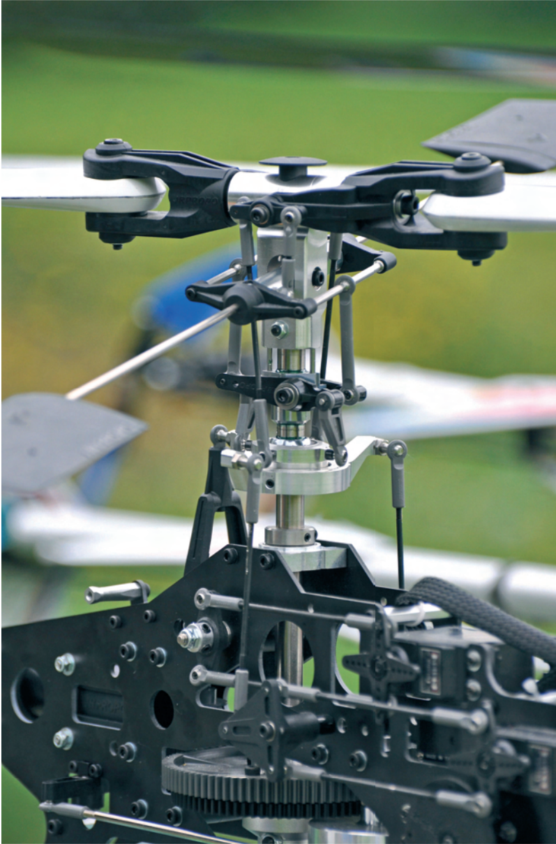
Bild 1.2: Rotorkopf und darunter liegende Taumelscheibe.
