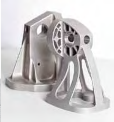
Prototyp einer optimierten Halterung eines Airbus A380, gefertigt im DMLS-Verfahren (Direct Metal Laser Sintering), kurz, aus Edelpulver. Hinten die herkömmliche Halterung. (Quelle: Airbus Group Innovations)
