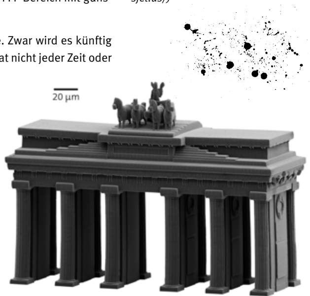
Das kleinste Brandenburger Tor der Welt mit ca. 0.15 mm Höhe. Hergestellt im 3D-Laserlithographie-Verfahren. (Quelle: www.nanoscribe.de )
