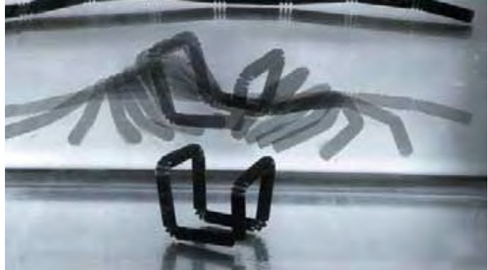
3D-gedruckter Strang, der sich selbst zu einem Würfel zusammenfaltet. Gemeinschaftsprojekt von Stratasys und dem MIT. (Quelle: http://www.sjet.us/ )
