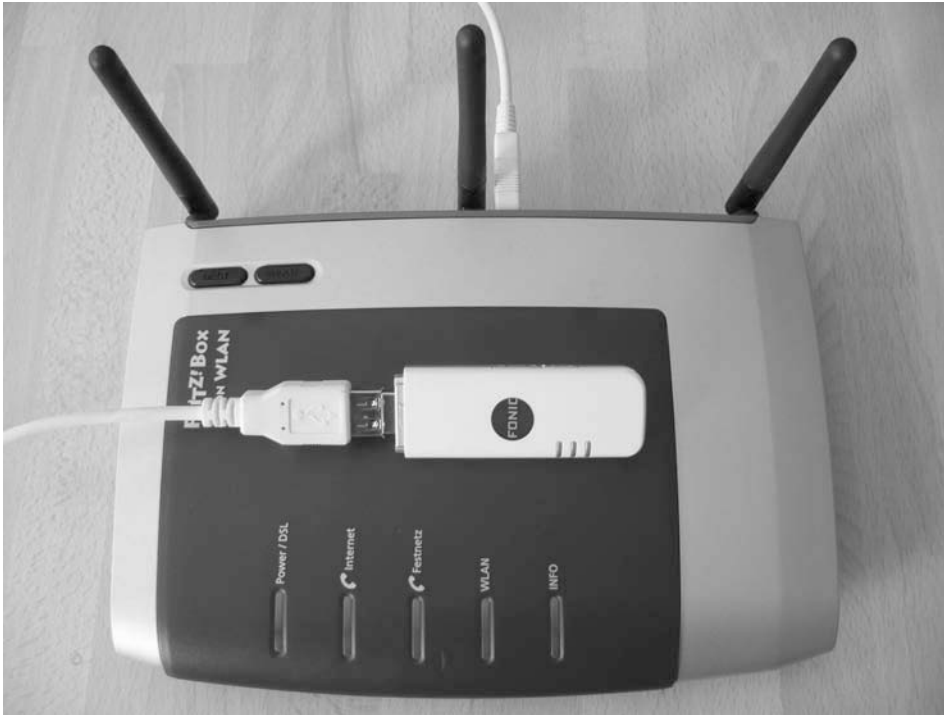
Bild 1.13: Manche Heimnetzrouter mit USB-Schnittstelle, wie diese FRITZ!Box 7270 von AVM, können eine Onlineverbindung zur Not auch per UMTS bereitstellen.
