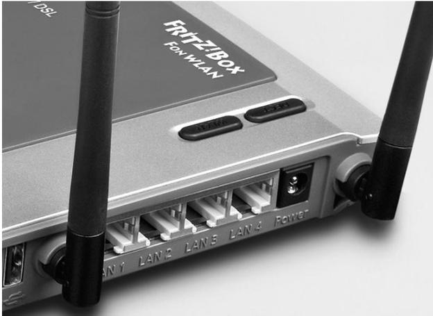
**Bild 3.4:** Der Switch (LAN 1 bis LAN 4) befindet sich immer an der Rückseite des Heimnetzrouters. (Quelle: [www.avm.de](http://www.avm.de))
