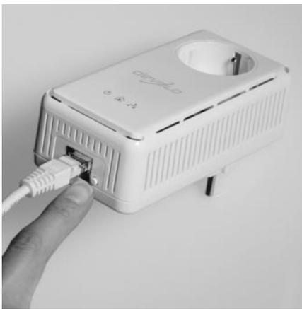
**Bild 3.32:** Drücken Sie dieses Knöpfchen zunächst zehn Sekunden. Dazu muss der Adapter – anders als in dieser Abbildung – jedoch in einer Steckdose eingesteckt sein. (Quelle: [www.devolo.de](http://www.devolo.de))
