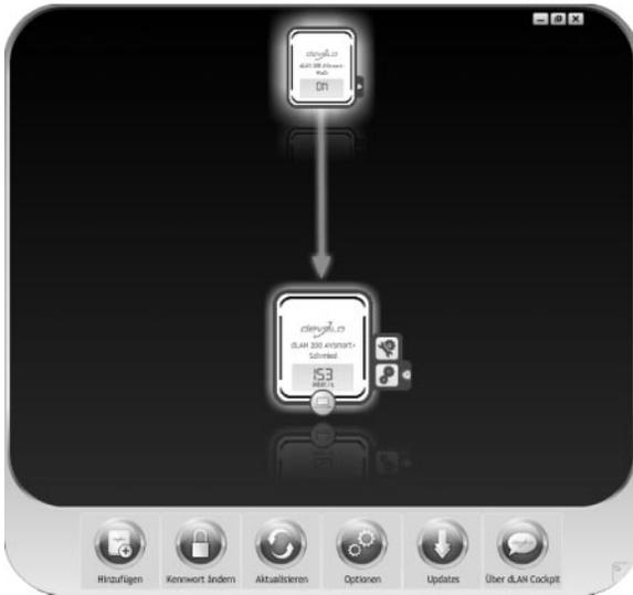
**Bild 3.34:** Devolos kostenloses Monitoring-Tool Cockpit zeigt die aktuelle Bruttodatenrate zwischen PLC-Adaptern an.
