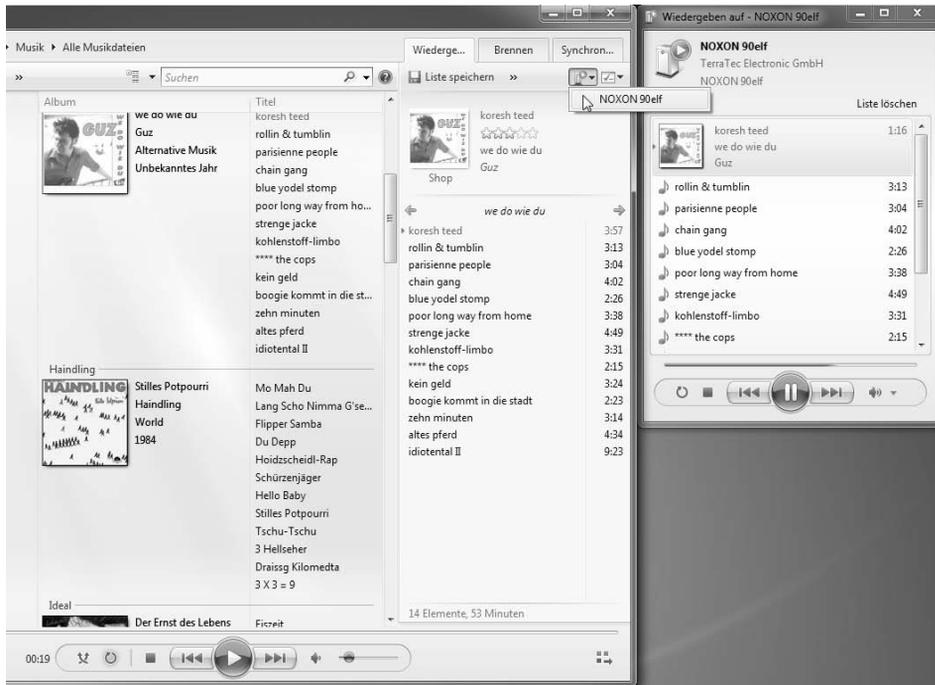
**Bild 10.4:** Der Windows Media Player funktioniert hier als Control Point, indem er Songs auf einen Streaming-Client sendet, hier das Webradio *NOXON 90elf*, der diese dann abspielt.
