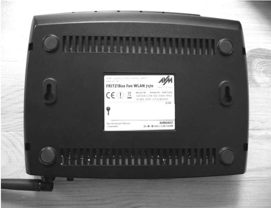
**Bild 3.17:** Selbst ältere Routermodelle von AVM waren bereits mit Aussparungen zur Wandbefestigung versehen (die beiden birnenförmigen Löcher links und rechts vom silbernen Aufkleber).
