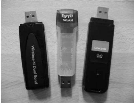
**Bild 3.22:** Dualband-USB-Adapter (hier: Netgear, AVM, Cisco/Linksys) können wahlweise Verbindungen mit 2,4- oder 5-GHz-Access-Points eingehen.
