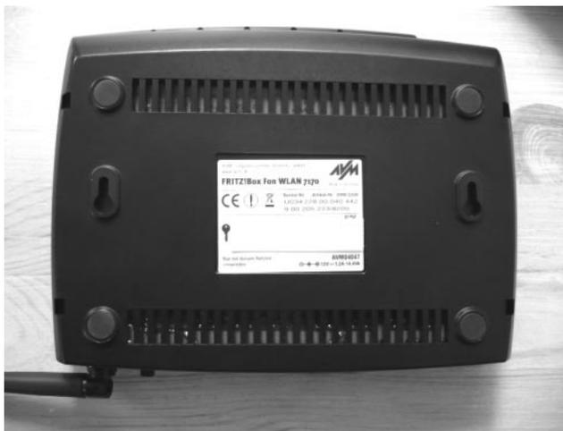
**Bild 3.26:** Die SSID (hier: FRITZ!Box Fon WLAN 7170) und der WPA-Schlüssel (hier: 81...) sind bei vorverschlüsselten WLAN-Routern meist auf der Geräteunterseite abgedruckt.
