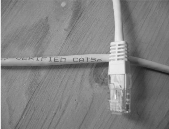
**Bild 3.13:** Die Bezeichnung des Kabelstandards ist immer auf dem Netzkabel abgedruckt, hier CAT5e.
