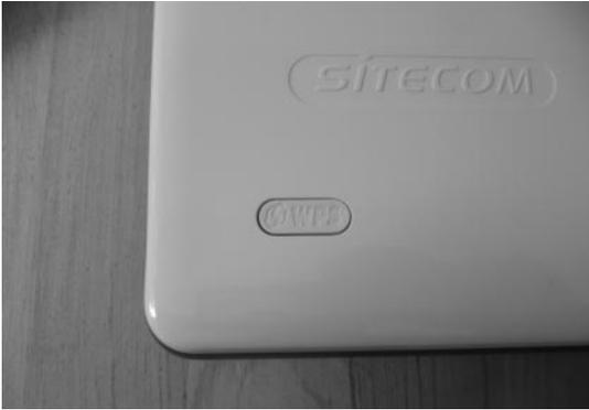
**Bild 3.23:** Aktuelle Router mit WLAN-Access-Point unterstützen WPS und besitzen einen entsprechenden WPS-Knopf außen am Gerät.
