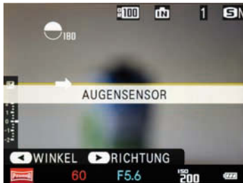
▲ Der Augensensor schaltet das Display aus.
