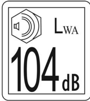
Abb. 1.23: Piktogramm des garantierten Schallleistungspegels (Quelle: Richtlinie 2000/14/EG)
