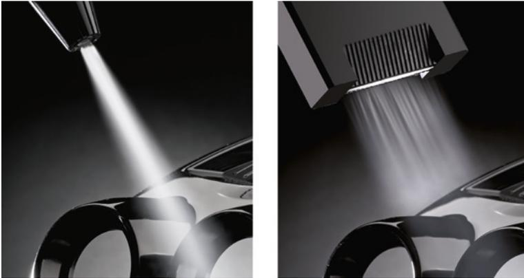
**Bild 2.18** links: Runddüse (CleanIce-Perfect); rechts: Flachdüse (CleanIce-DustFree)
