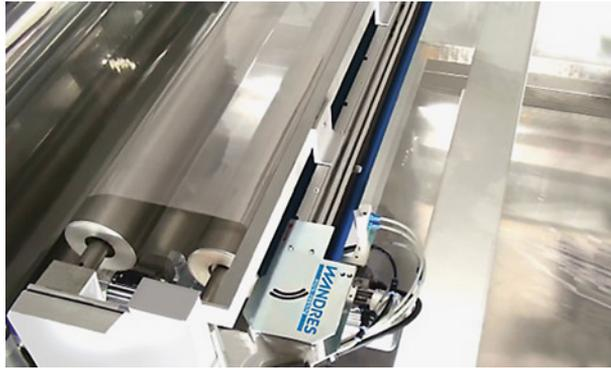
**Bild 2.6** Linearbürste im Eingriff im Bereich einer Umlenkwalze (Werkbild: Wandres GmbH) [7]
