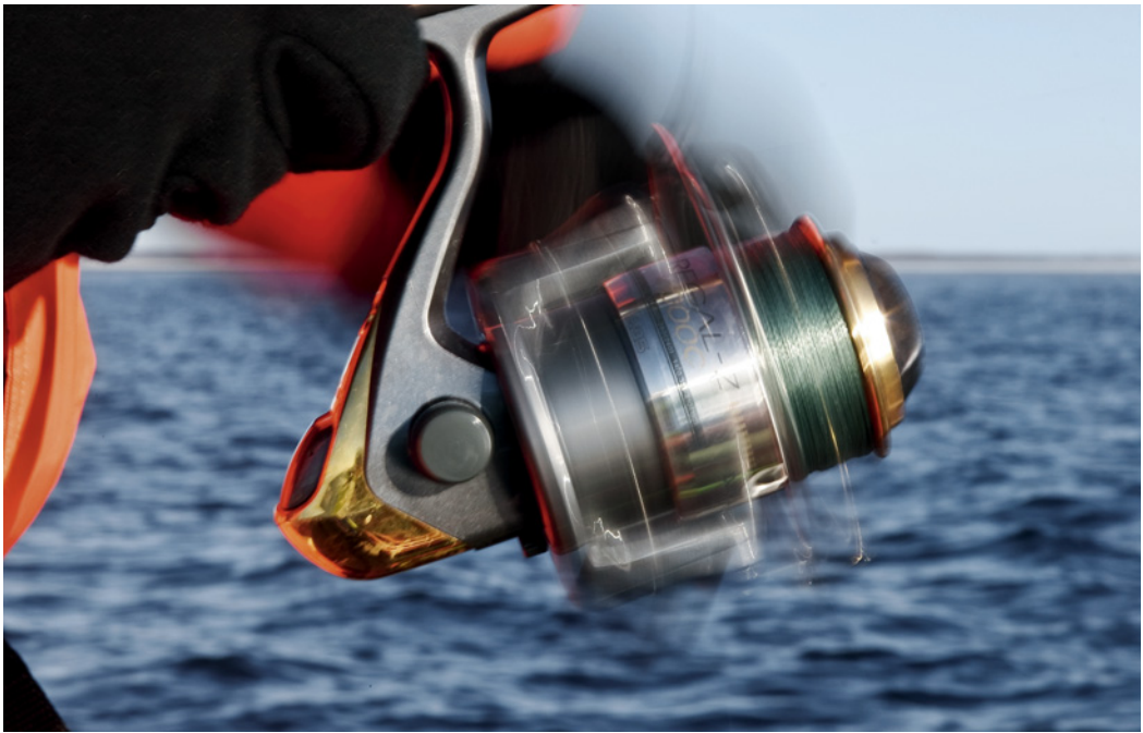
Die Übersetzung der Rolle gibt Auskunft darüber, wie oft sich der Rotor mit einer Kurbelumdrehung um die Spule dreht.
