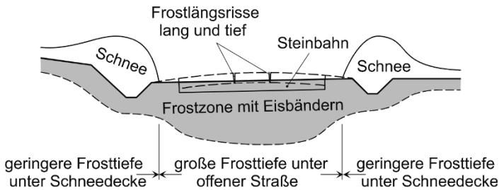
Bild 2-5 Frosthebung einer Packlagendecke bei frostempfindlichem Untergrund (nach [271])
