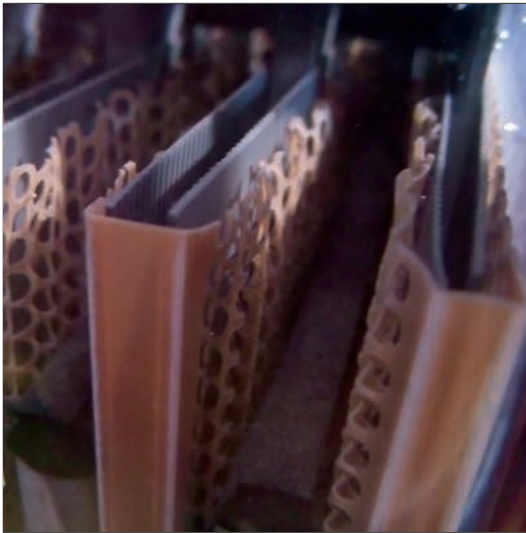
Bild 2.2 Doppelseparatoren in einer Batterie.
