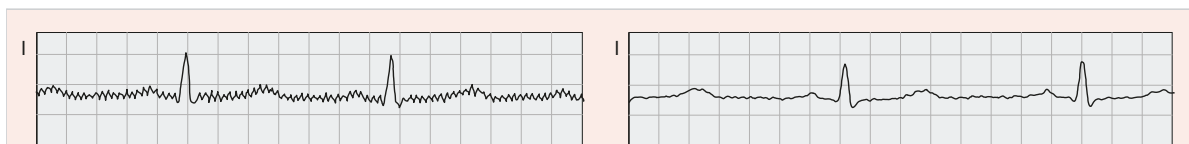
Abb. 3.2 EKG-Ableitung ohne (links) und mit 50-Hz-Filterung (rechts).
