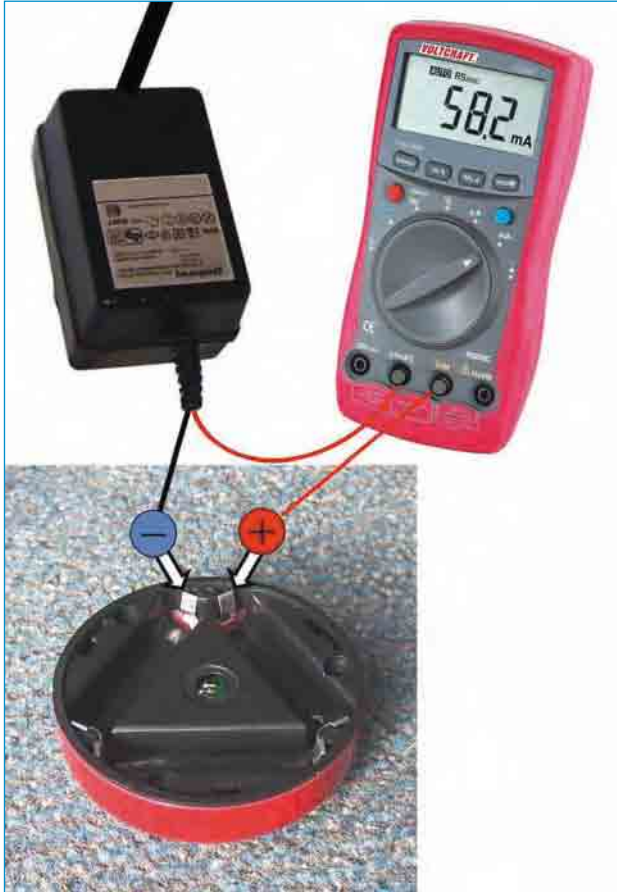
Abb. 4.17 – Ermittlung des Stromverbrauchs der LED-Leuchte mit einem Multimeter.
