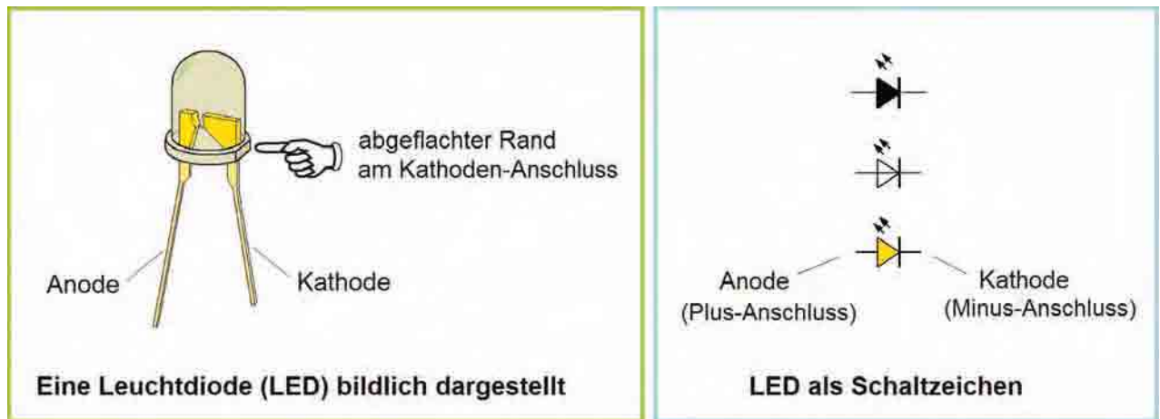
Abb. 1.1 – Leuchtdiode (Standard-Radialform) in natura und als Schaltzeichen
