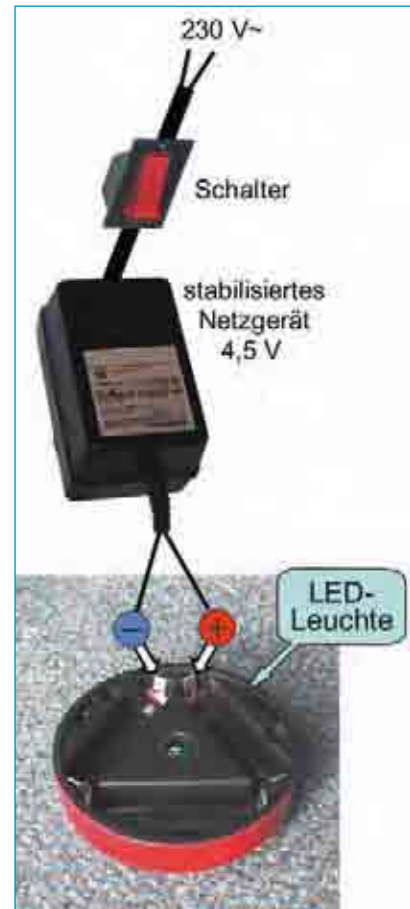
Abb. 4.16 – Anstelle der Batterien kann ein kleines stabilisiertes Netzgerät die Stromversorgung übernehmen.
