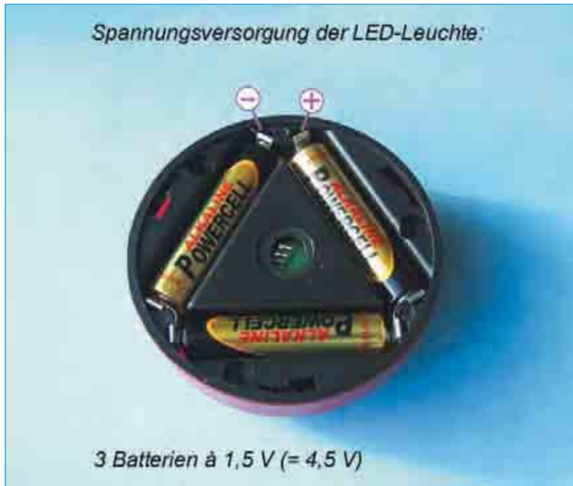
Abb. 4.15 – Für die Spannungsversorgung der LED-Leuchte aus Abb. 4.14 sind drei Alkalibatterien à 1,5 V zuständig (Rückseitenansicht).
